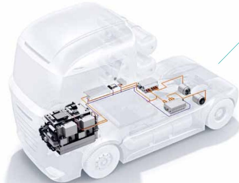
Bosch propose différentes solutions pour les systèmes de piles à combustible mobiles afin de répondre aux exigences des clients partout dans le monde : du stack qui constitue le cœur du dispositif au système complet destiné aux véhicules utilitaires en passant par les différents composants présents dans les sous-modules.
